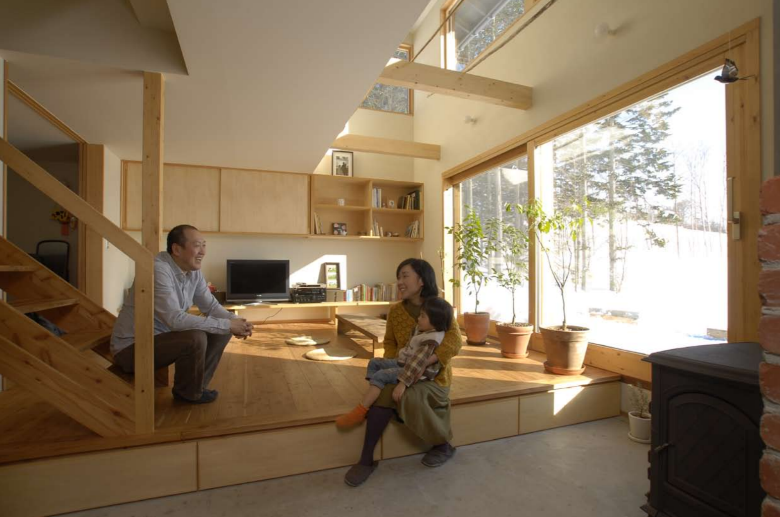
床下蓄熱型サーマースラブを用いた土間で暖房し、補助的に薪ストーブを。薪ストーブ周辺のレンガは自分たちで積んだ。珪藻土の壁も自分たちで塗装。この家への愛着もいっそう増す
